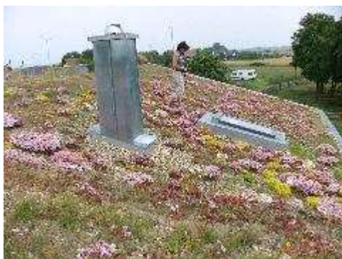
Bei Berlin - 400 m 2 Versuchsdachflächen zur Erprobung kostenoptimierter Langzeit- Schutzbegrünungen und diverser FP□- Dachabdichtungen bei Steil- und Flachdächern
